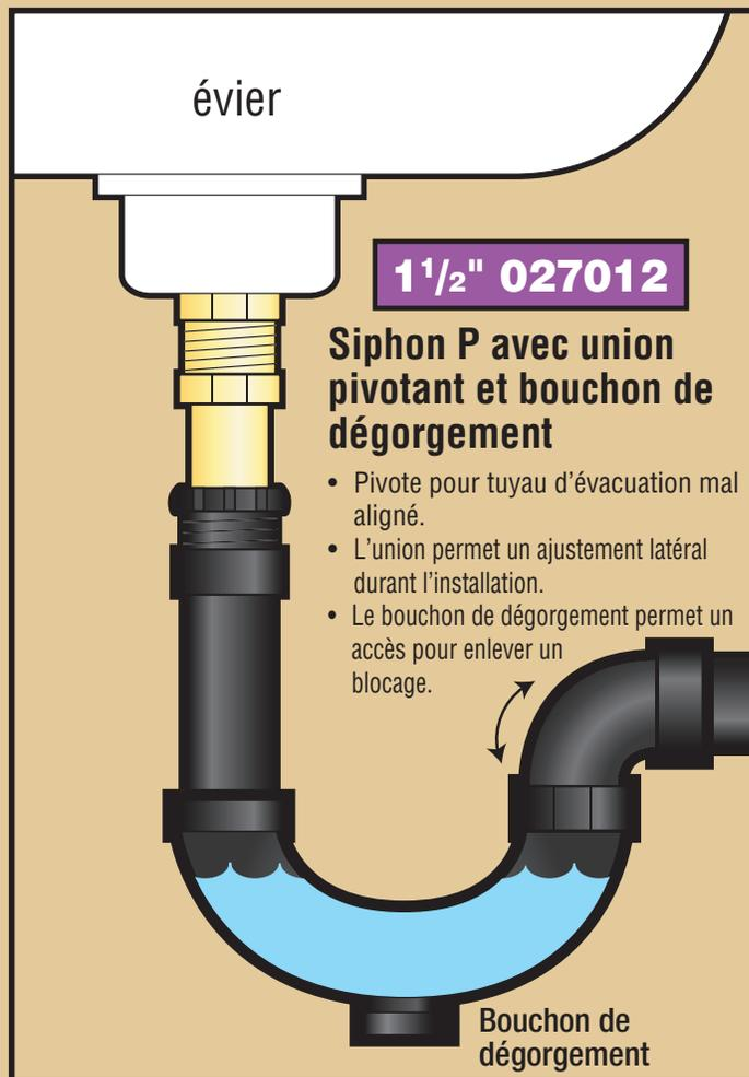
**Siphon P avec union pivotant et bouchon de dégorgement**
