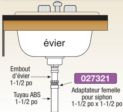
Utiliser un adaptateur femelle pour siphon lorsque vous attachez l'embout de l'évier au tuyau
