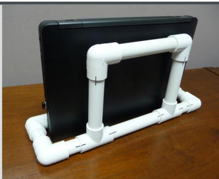
identique pour l'autre côté. Continuer de cette façon pour les supports verticaux. N'oubliez pas d'ébavurer les bords extérieurs des tuyaux coupés avant le collage au solvant
